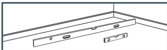
La pose doit être réalisée sur un support plan, propre, sain, sec et solide.
