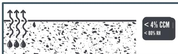
Le taux d'humidité ne doit pas excéder 4 % au test de la bombe à carbure (Control Carbide Moisture) et ne doit pas avoir de risque de remontées d'humidité
